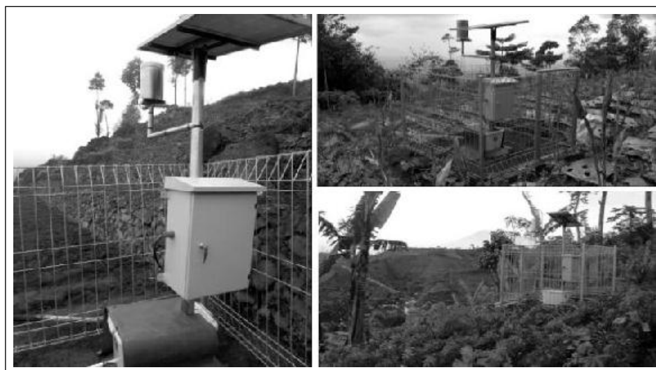
Gambar 7. Alat Sistem Peringatan Dini Menggunakan Ekstensometer di Kabupaten Wonosobo, Provinsi Jawa Tengah.
