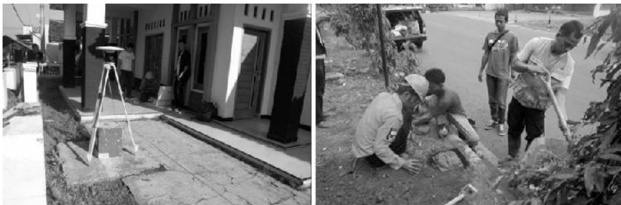
Gambar 5. Kegiatan Pemantauan Gerakan Tanah Pada Jalur Jalan Nasional Moh. Isa di Desa Purwaharja, Kecamatan Purwaharja, Kota Banjar, Provinsi Jawa Barat Menuju Provinsi Jawa Tengah.
